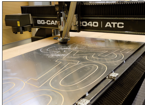
Dicke Materialien bearbeitet Werner+Plank mit einer CNC-Fräse, dünnere mit einem Laser.
